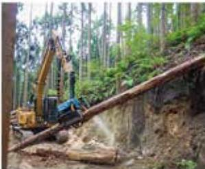
林業はチェーンソー手に木を行ひ廻すといったイメージが強いですが、実際には専門的機器が導入されているので伐根のほとんどは機械で効率的に行います。この伐根はハーベスターといって、先端のアッパー部で枝崩し・五切り（油材）、葉穀の作業を全て一台で行います。
